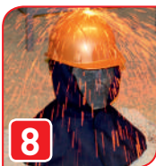
Испытания на брызги расплавленных металлов
