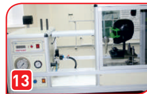
Испытания на устойчивость к удару высокоскоростных частиц
