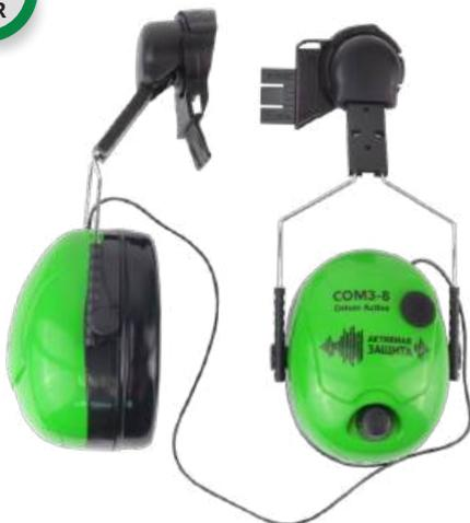
Избирательное поглощение шума: наушники защищают от воздействия шума до 109 дБ, давая возможность различать речь и сигналы опасности.
