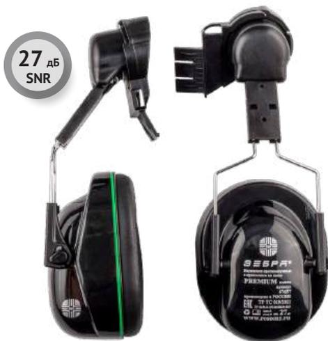
Избирательное поглощение шума: наушники защищают от воздействия шума до 107 дБ, давая возможность различать речь и сигналы опасности. Держатели чашек регулируются по высоте вдоль рычагов. Универсальные адаптеры для крепления наушников к корпусу каски защитной, адаптеры дают возможность крепления щитков защитных лицевых. Две точки крепления оголовья к чашке обеспечивают плотное, равномерное прилегание амортизаторов, без давления, гарантируют улучшенное шумопоглощение.
