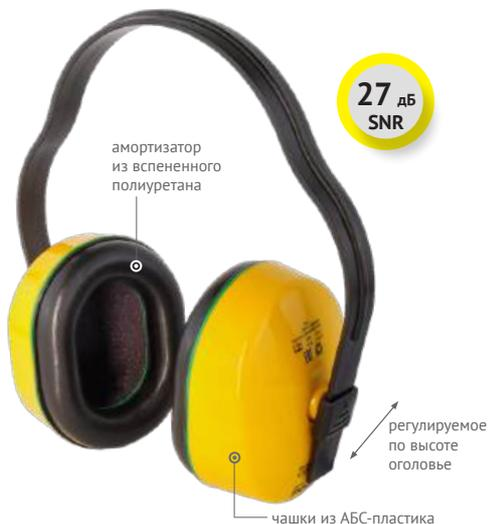
Избирательное поглощение шума: наушники защищают от воздействия шума до 107 дБ, давая возможность различать речь и сигналы опасности. Наушники диэлектрические: нет ни одной металлической детали. Регулируемое оголовье равномерно распределяет давление чашек на голову, обеспечивая плотное прилегание к голове. Хорошо заметны в сумерках, в условиях плохой видимости или недостаточной освещенности, часто возникающих при дорожных, строительных и других работах.
