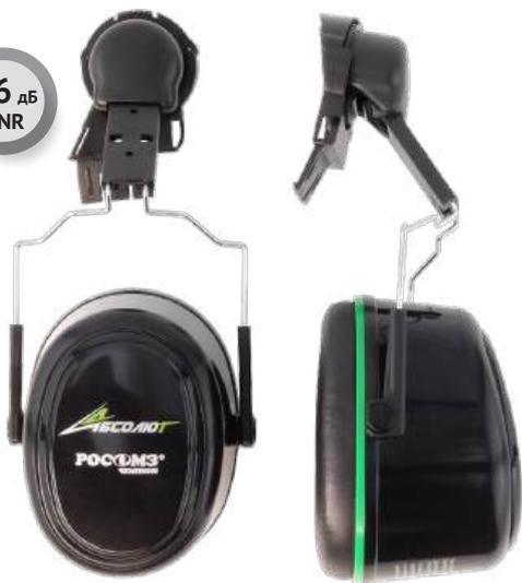
Избирательное поглощение шума: наушники защищают от воздействия шума до 116 дБ, давая возможность различать речь и сигналы опасности. Держатели чашек регулируются по высоте вдоль рычагов. Универсальные адаптеры для крепления наушников к корпусу каски защитной, адаптеры дают возможность крепления щитков защитных лицевых. Две точки крепления оголовья к чашке обеспечивают плотное, равномерное прилегание амортизаторов, без давления, гарантируют улучшенное шумопоглощение.
