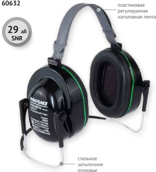
Избирательное поглощение шума: наушники защищают от воздействия шума до 109 дБ, давая возможность различать речь и сигналы опасности. Регулируемая наголовная лента легкообрабатываемая, выдерживают многократное мытье и обеззараживание. Возможность ношения с каскеткой защитной, очками, щитками защитными лицевыми, подшлемником.
