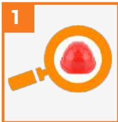
Каждый раз перед началом эксплуатации произвести визуальный осмотр, проверить комплектность и отсутствие на каске сколов, вмятин, сквозных трещин, а также нарушение целостности внутренней оснастки.
