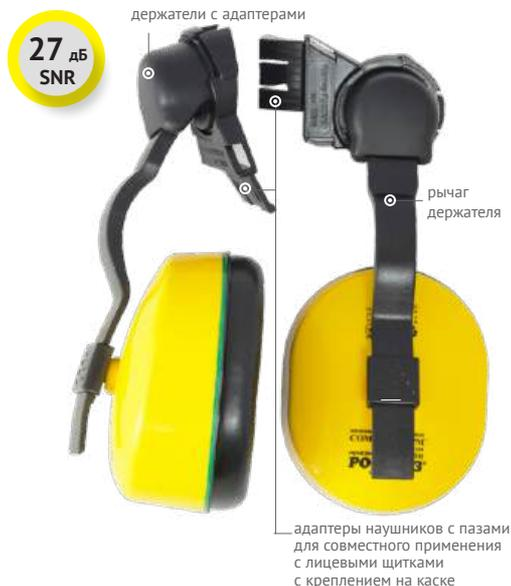
Избирательное поглощение шума: наушники защищают от воздействия шума до 107 дБ, давая возможность различать речь и сигналы опасности.
