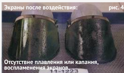
Отсутствие плавления или капания, воспламенения экранов.
