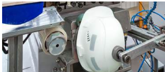
Светоотражающая печать для повышения безопасности в темное время суток
