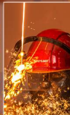
Расплавленный до 1400^{\circ}\text{C} металл выливают на щиток защитный лицевой
