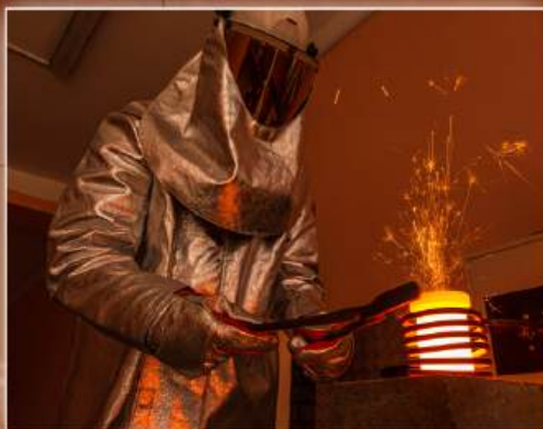
Индукционный нагрев тигеля с металлом токами высокой частоты
