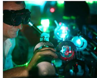
Для защиты глаз от случайного воздействия лазерного излучения используют специальные защитные очки.
